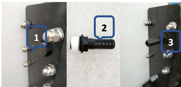
MONTAJE TOMA AGUA DE MAR
